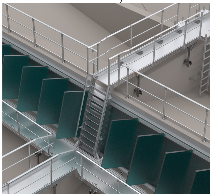
Interseção entre escadote com degraus, passarela e escada.
